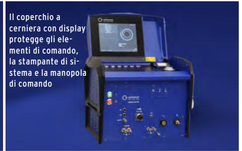
Il coperchio a cerniera con display protegge gli elementi di comando, la stampante di sistema e la manopola di comando
