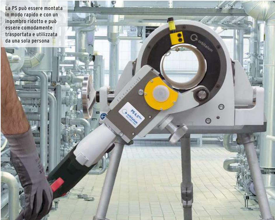
La PS può essere montata in modo rapido e con un ingombro ridotto e può essere comodamente trasportata e utilizzata da una sola persona
