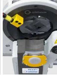
Secondo supporto della lama per il taglio di curve
