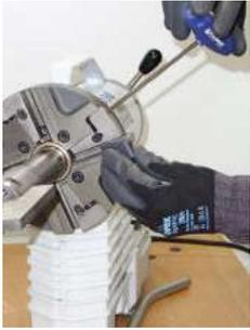
Sistema di serraggio rapido dell'utensile QTC® (Quick Tool Change)
